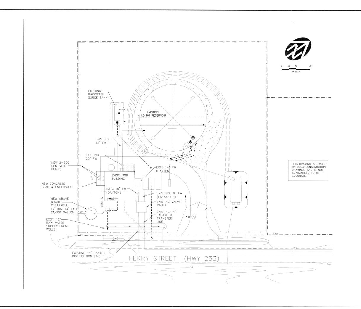
BACKWASH CLEARWELL AND BOOSTER PUMP LAYOUT
